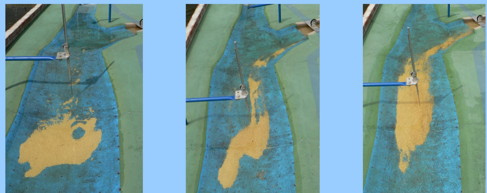
Abb. 4, 5 und 6: Sedimenttransport im Zulauf der Wehranlage bei MQ, Q_{330} und BHQ
